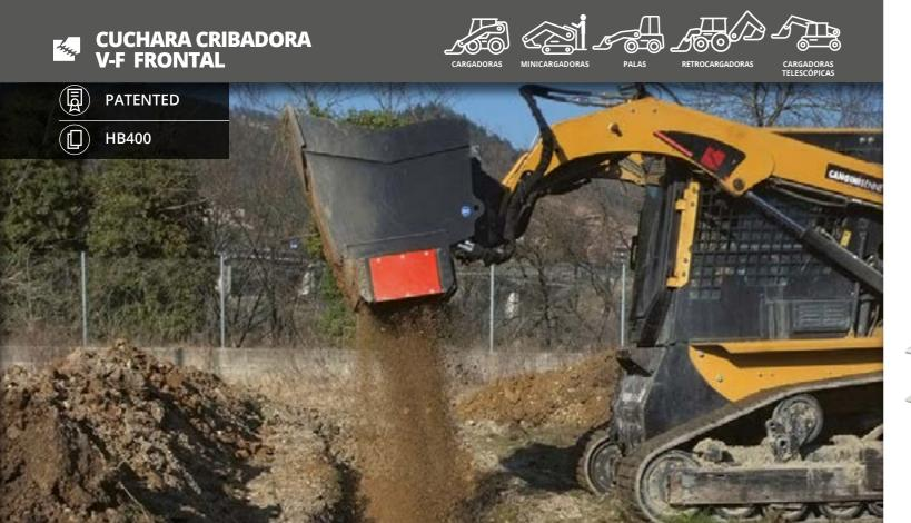
SE UTILIZA PARA LA SELECCIÓN DE ESCOMBROS DE DEMOLICIÓN, EXCAVACIONES Y MOVIMIENTO DE TIERRAS EN GENERAL. TAMBIÉN ES ÚTIL PARA LA MEZCLA DE TERRENOS CON TURBA. EL CRIBADO SE REALIZA MEDIANTE UNA CRIBA HIDRÁULICA CON CUCHILLAS GIRATORIAS EN HB400. EL ESPESOR DEL MATERIAL CRIBADO PUEDE VARIAR DE 0-20 MM A 0-35 MM EN LA CONFIGURACIÓN ESTÁNDAR.
